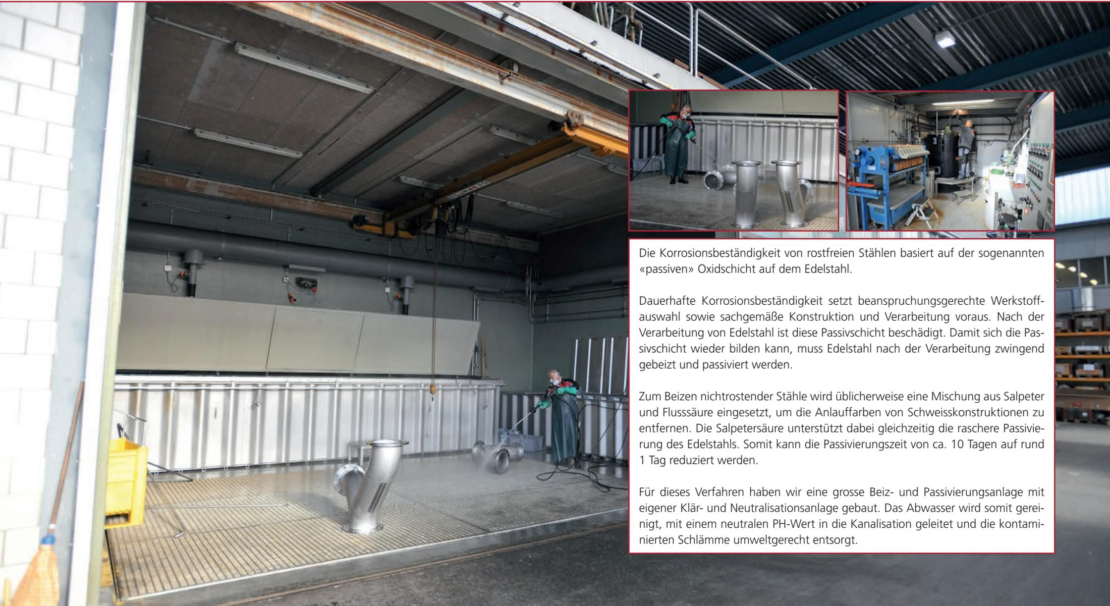
Die Korrosionsbeständigkeit von rostfreien Stählen basiert auf der sogenannten «passiven» Oxidschicht auf dem Edelstahl.
