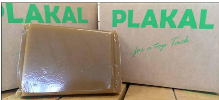
Am Ende des Herstellungsprozesses entstehen Kissen à 2,5 kg mit gebrauchsfertigem Klebstoff.
